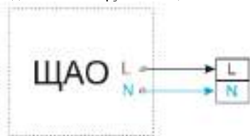
Рис. №1 Схема подключения к групповой цепи питания.
